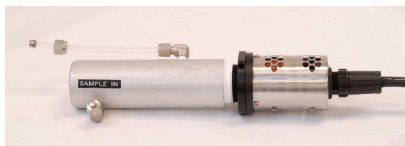
Insertion dans une chambre de circulation (orifine ouvert) pour les bas points de rosée
