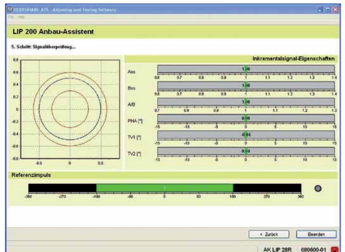
Mise en service avec le PWM 20 et le logiciel ATS
