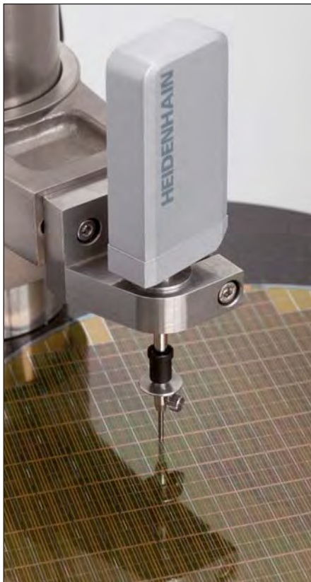
Mesure de l'épaisseur de wafers en silicium
