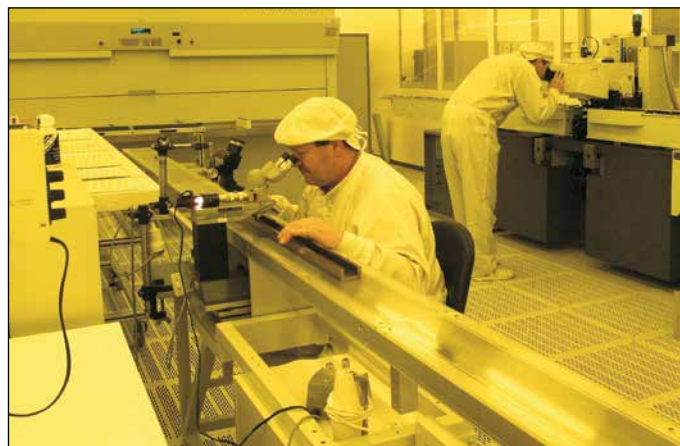
Poste de contrôle des règles de mesure dans la zone de lithographie
