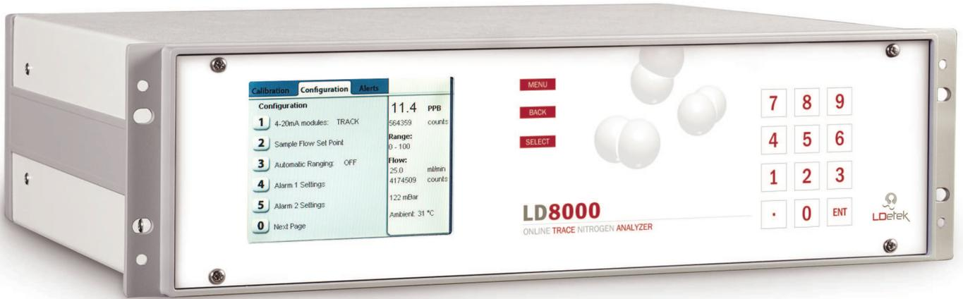
Contrôle continu de la pureté d'Argon par la mesure des ppmV de N<sub>2</sub>, par la technique du Plasma à émission lumineuse. Le générateur, grâce à sa haute intensité et haute fréquence, et par son installation autour de la chambre d'émission offre un rendement et une stabilité unique au plasma d'Hélium, ou d'Argon ou d'Azote.
