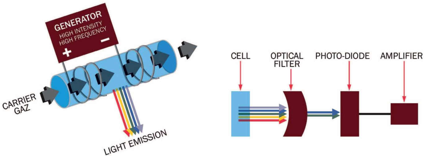
L'électroluminescence générée, spécifique à chaque gaz est convertie, grâce à une photodiode, en courant directement proportionnel à la concentration des gaz.
