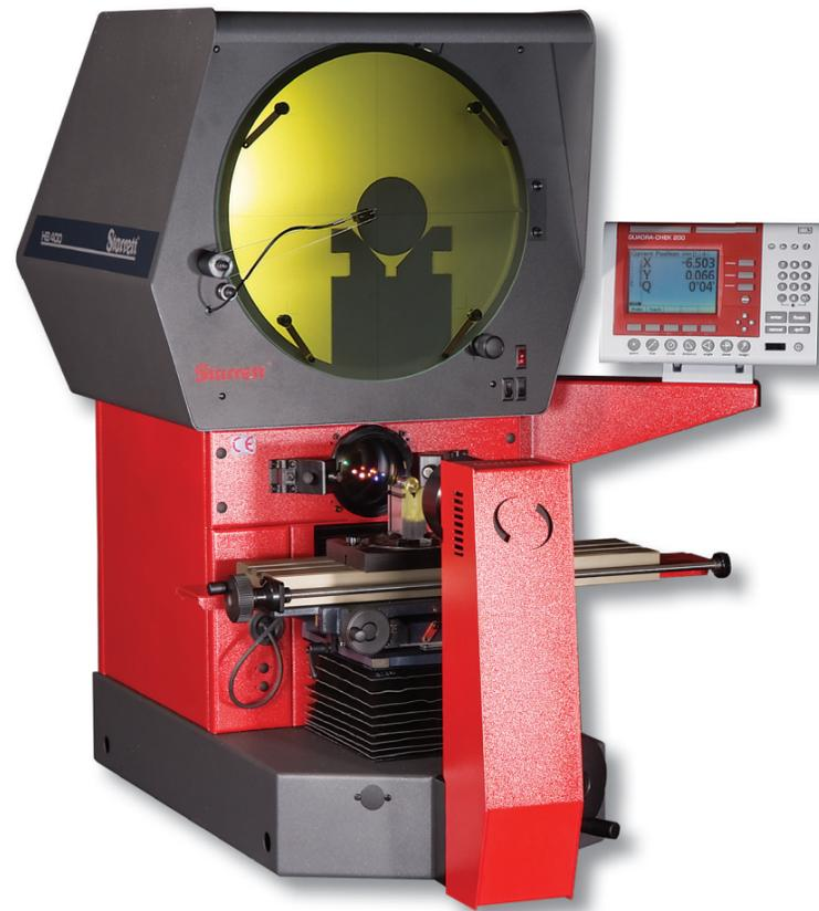
Le HD400 offre une image verticalement corrigée sur un écran entièrement utilisable de 400 mm de diamètre. Grâce à sa capacité largement supérieure, ce projecteur offre une gamme de mesures qui était jusqu'à présent uniquement disponible avec des appareils sur bâtis.
