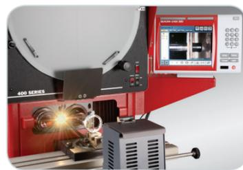
Sur un projecteur HD400, l'OV2 permet de réaliser immédiatement des mesures optiques et vidéo sans modifier la mise en place de la pièce.
